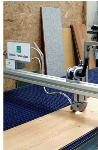
Abb. 2: Messkopf für Online-Farbmessungen an Plattenoberflächen
