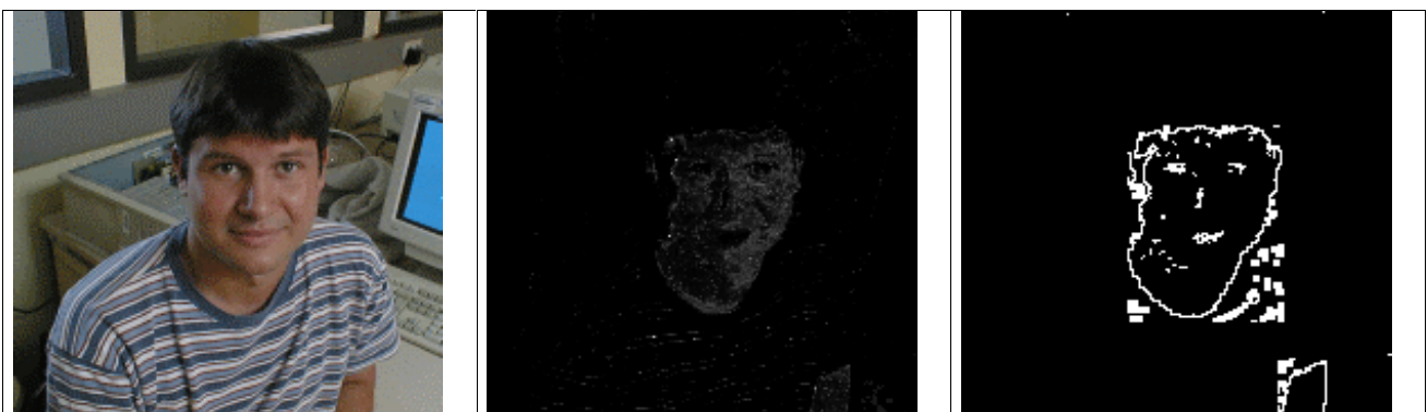
Abbildung 5 Berechnung zunächst des farbsegmentierten Bildes und anschließend des des Kantenbildes als Ausgang für die heuristische Formanalyse.
